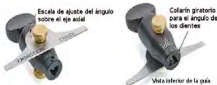
Sirve para ajustar la inclinación sobre el eje axial de la hoja del serrucho. Presenta el dispositivo un collarín rotativo ajustable en incrementos de 1° con escala Vernier (doble calibrado de precisión o nonio de algunos instrumentos de medición) para ajustar el ángulo de inclinación de los dientes positivo o negativo con un rango de ±30°. Proporciona una segunda empuñadura de sujeción de las limas de afilado ayudando a controlar el ángulo de ataque sobre los dientes del serrucho. Peso: 150 g.
