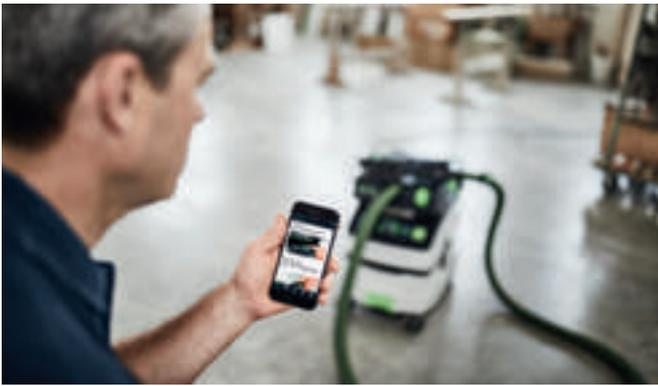
Para un trabajo sin interrupciones, el aspirador indica si tiene algún problema: la app Work le ofrece la ayuda adecuada mediante notificación push directamente en el smartphone.
