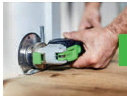
**Sistema de fijación rápida con alojamiento de herramienta StarlockMax**
