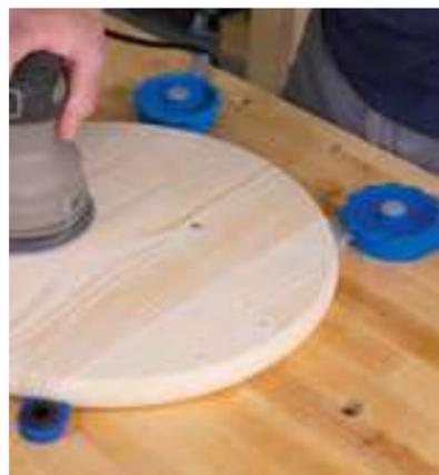
La zapata de la abrazadera puede sujetar formas planas y redondeadas, así como ángulos de 90°.
