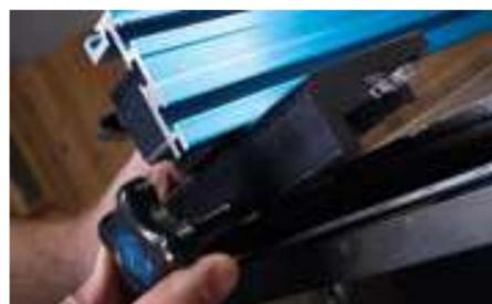
Retira el brazo en segundos, sin necesidad de herramientas. Basta con aflojar el pomo de bloqueo y levantar la guía del carril de montaje. El riel está fuera del alcance de la superficie de la mesa.
