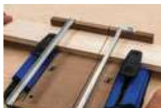
Una línea de puntuación que se corta en la base de MDF para ver exactamente donde su sierra va a cortar.
