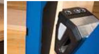
La pinza de doble acción con Automaxx® sujeta la pieza automáticamente y se ajusta al grosor correcto del material.
