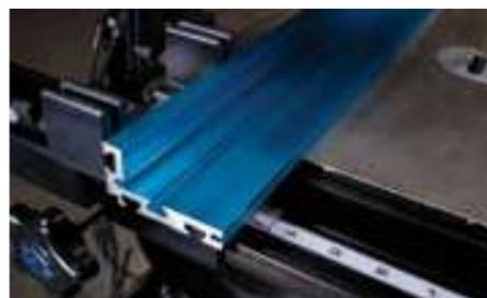
Cambia rápida y fácilmente de un brazo alto a uno bajo para cortar piezas más finas sin cambiar los ajustes de perpendicularidad y deriva de la hoja. Cambia de brazo con la misma facilidad.
