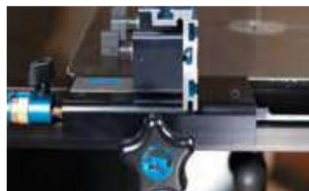
Coloca el brazo perpendicular a la superficie de tu mesa y ajusta el ángulo para compensar la desviación de la hoja con los tornillos de fijación que simplemente se ajustan y sujetan firmemente para obtener resultados fiables.
