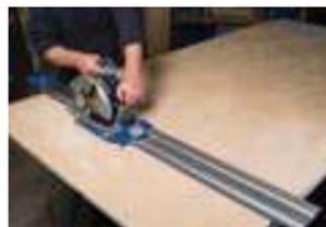
El riel se mantiene en su lugar gracias a la superficie antideslizante y antidescargas en la parte inferior de la barra guía, por lo que no hay necesidad de una pinza para hacer la mayoría de tus cortes. Existen abrazaderas opcionales (abajo) para utilizar esta herramienta en materiales con una superficie resbaladiza, como la melamina o el contrachapado precabado.
