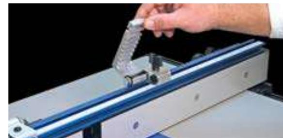
El diseño permite que el tope se retraiga cuando no se utiliza.
