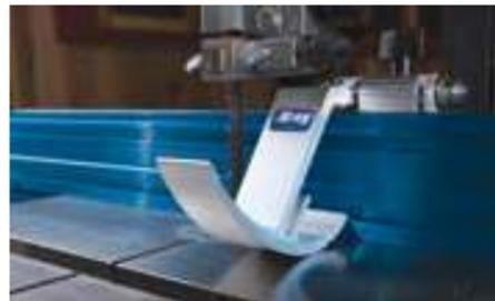
Añada al brazo un Swing Stop™ o un tope de producción que facilite cortes precisos y repetibles de una profundidad definida, como la necesaria para cortar espigas.
