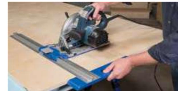
Los cortes rectos se facilitan con una guía de borde sobredimensionada con un mango que proporciona control durante todo el corte siguiendo el borde de su placa.
