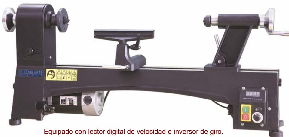
Equipado con lector digital de velocidad e inversor de giro.
