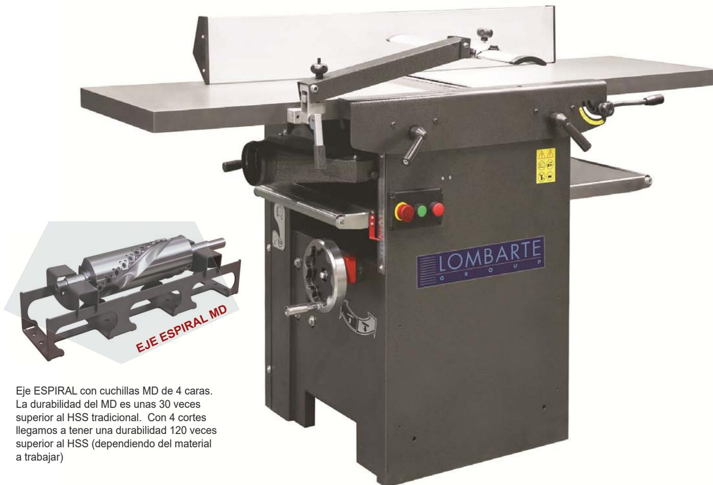
Eje ESPIRAL con cuchillas MD de 4 caras. La durabilidad del MD es unas 30 veces superior al HSS tradicional. Con 4 cortes llegamos a tener una durabilidad 120 veces superior al HSS (dependiendo del material a trabajar)
