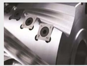
Eje doble espiral con cuchillas MD
