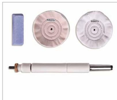
Compuesto por un eje de 8mm cono morse MT2, espaciador de teflón, dos ruedas pulido de 100 mm y una pastilla de pulimento. Especialmente diseñado para el acabado de bolígrafos fabricados en acrílico.
