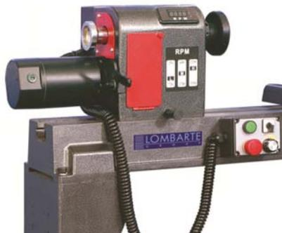
Modelo con variador electrónico y motor de escobillas.
