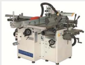
Separable en dos partes para paso de puertas de 72 cm.
