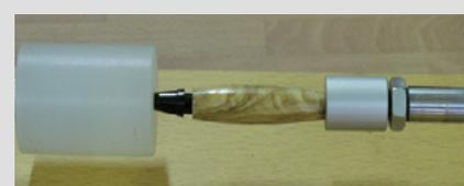
El ensamblado del puntero deberá realizarse SIEMPRE con materiales no féreos: un mazo de madera, prensa de nylon, plástico, etc.
