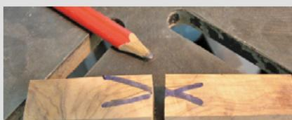
Cortarlas conforme a las medidas de los tubos. Es importante marcarlas para que el veteado coincida y no desmerezca el resultado final.
