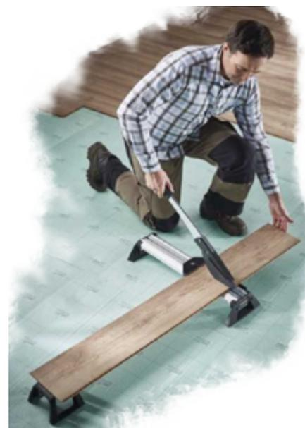
**VLC800** Para laminados de hasta 11 mm de grosor y 465 mm de ancho. Permite cortes angulares desde 0° a 180°. Práctico tope longitudinal para recorte de tiras de 55 mm de ancho, tanto a derechas como a izquierdas. Incluye función de sujeción para cortar con facilidad y comodidad paneles muy anchos y soporte para apoyar los paneles.
