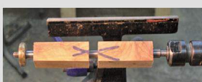
Montar las piezas perforadas sobre el mandril de torneado, en la fotografía el de cono morse 2 PKM-PFL, de forma que coincida el veteado. Utilizar las anillas.
