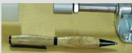
Montaje manual del mecanismo Introduciendo la anilla central y a presión manual proceder al montaje final del bolígrafo.
