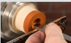
4. Se tornea el hueco interior. Debe comprobarse con el anillo la medida hasta que pueda insertarse en dicho agujero.
