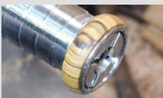
6. Desmonte cuidadosamente la pieza del torno. Encole el anillo y elimine el excedente de cola. Monte la pieza en el mandril para anillos fijándola firmemente y torne a su gusto. Remate el trabajo con un lijado fino. Aplique el acabado de su agrado.
