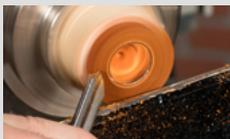
5. Inserte el anillo en el agujero hasta el fondo y recorte torneando el ancho de la madera para que coincida con el anillo, con cuidado para no dañar el alma de acero.
