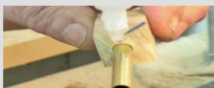
Impregnar de adhesivo y en sentido horario introducir los tubos de los mecanismos. Usar preferiblemente un adhesivo de viscosidad intermedia.
