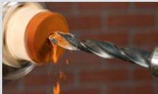
3. Se tornea el exterior. Tras ello se realiza el perforado interno con una broca de un tamaño que permita usar la gubia correspondiente con la que efectuar el ajuste.
