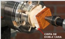
2. Lije perfectamente la base, para poder fijarse con cinta de doble cara en una pieza auxiliar donde torneare entre puntos el cuerpo de madera.
